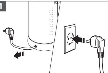
Das Kabel befindet sich in der Basis. Ziehen Sie das Kabel bei Bedarf vorsichtig heraus. Stecken Sie den Netzstecker in eine Schutzkontaktsteckdose.
