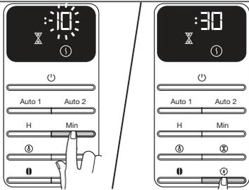
Drücken Sie die Taste **Min**, um die Minuten einzustellen. Speichern der angezeigten Uhrzeit und Beenden des Einstellmodus: Drücken Sie eine beliebige andere Taste, oder drücken Sie 10 Sekunden lang keine Taste.
