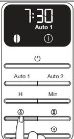
Einstellen der Plattentemperatur: Drücken Sie die Taste **Min**. Mit jedem Drücken können Sie zwischen niedriger Plattentemperatur „**1**“ oder hoher Plattentemperatur „**2**“ auswählen.
