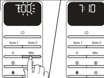
Drücken Sie die Taste **Min**, um die Minuten einzustellen. Speichern der angezeigten Uhrzeit und Beenden des Einstellmodus: Drücken Sie eine beliebige andere Taste, oder drücken Sie 10 Sekunden lang keine Taste.
