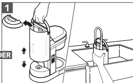
Heben Sie den Wassertank vorsichtig an. Füllen Sie den Wassertank mit frischem Wasser. Bringen Sie den Wassertank wieder zurück in die richtige Position.
