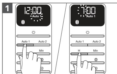
Drücken Sie einmal die Taste **Auto 1** oder **Auto 2**. Die Automateinstellung 1 oder 2 blinkt, und die Zeitanzeige wechselt zur aktuell eingestellten Zeit für die Automateinstellung 1 oder 2 (12:00 ist die Standardzeit).
